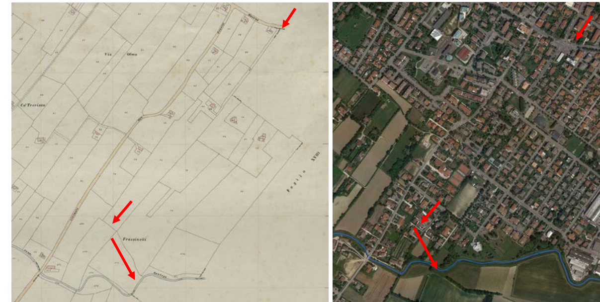
Confronto tra catastale d'impianto e ortofoto attuale (fonte Google Earth) con individuazione condotta principale
