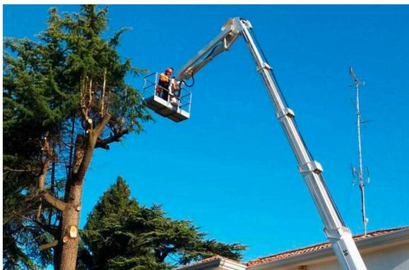
Utilizzate appropriati mezzi e macchine operatrici. Dotare il personale di adeguati DPI. Prima di effettuare il piazzamento del mezzo accertarsi della adeguata solidità e planarità della base di appoggio.
