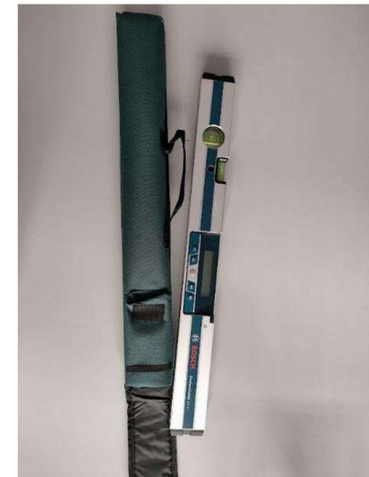
Figura 14: La livella elettronica utilizzata per i rilievi
