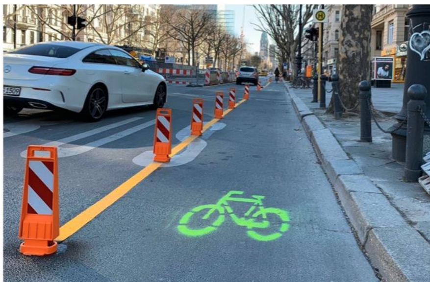
Figura 52: corsie ciclabili separate dalle corsie veicolari tramite dispositivi e segnaletica temporanea omologata. Fonte: Strade Aperte 2020
