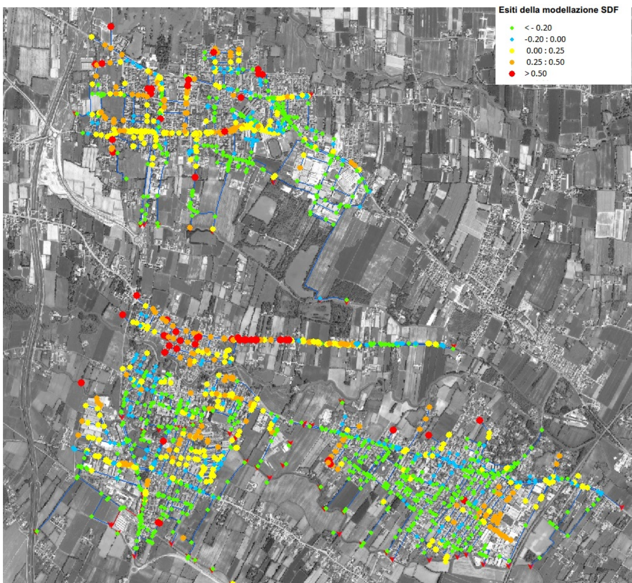
Figura 17. Schema della rete modellata con indicazione delle criticità ai nodi per un evento con TR 5 anni e durata 1 ora
