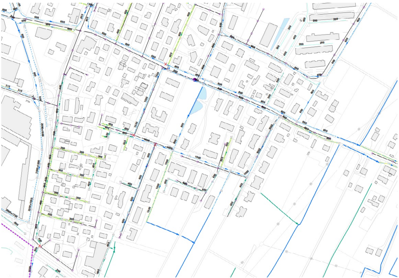
Figura 2. Estratto dalla carta di dettaglio delle reti idrauliche - Maerne (capofossi in azzurro e fossi in ciano, tratteggiata la rete minore tubata)
