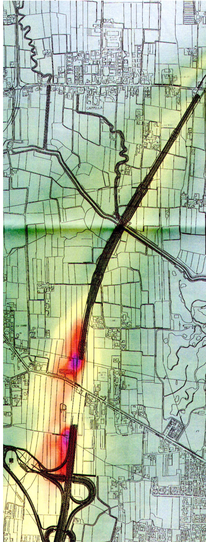
Distribuzione stimata di NOx nelle aree circostanti al tracciato del passante fonte: SIA del progetto del Passante Autostradale di Mestre
