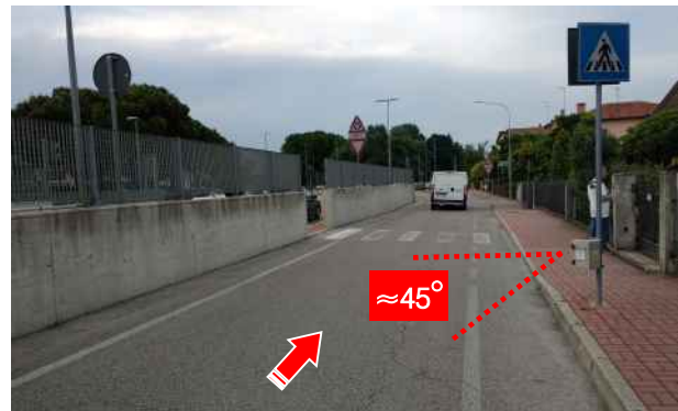
Figura 5.2 – Angolo di installazione dei radar rispetto alla direzione di marcia
