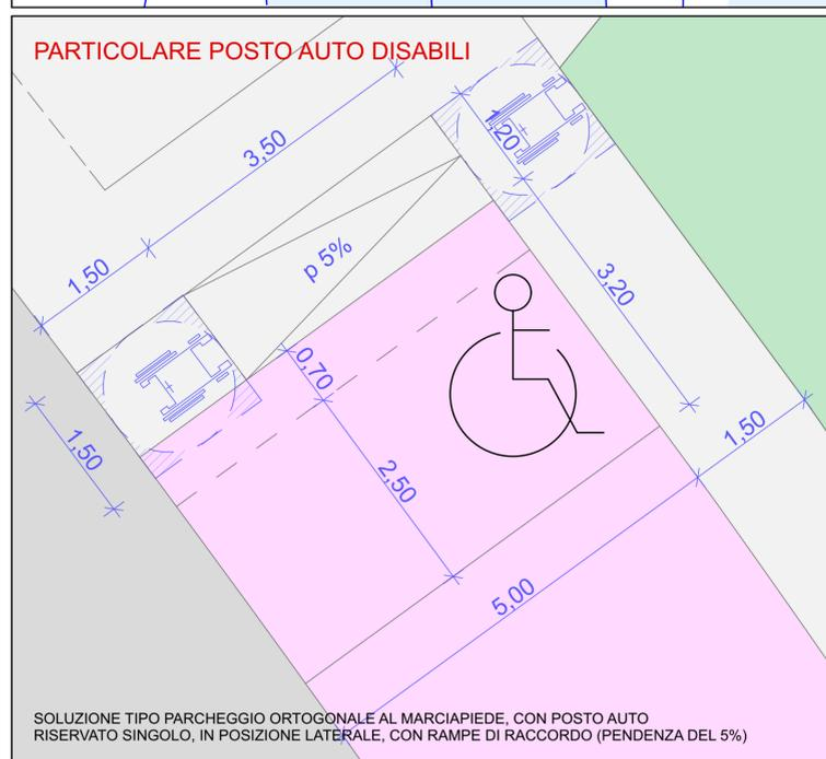
SOLUZIONE TIPO PARCHEGGIO ORTOGONALE AL MARCIPIEDE, CON POSTO AUTO RISERVATO SINGOLO, IN POSIZIONE LATERALE, CON RAMPE DI RACCORDO (PENDENZA DEL 5%)
