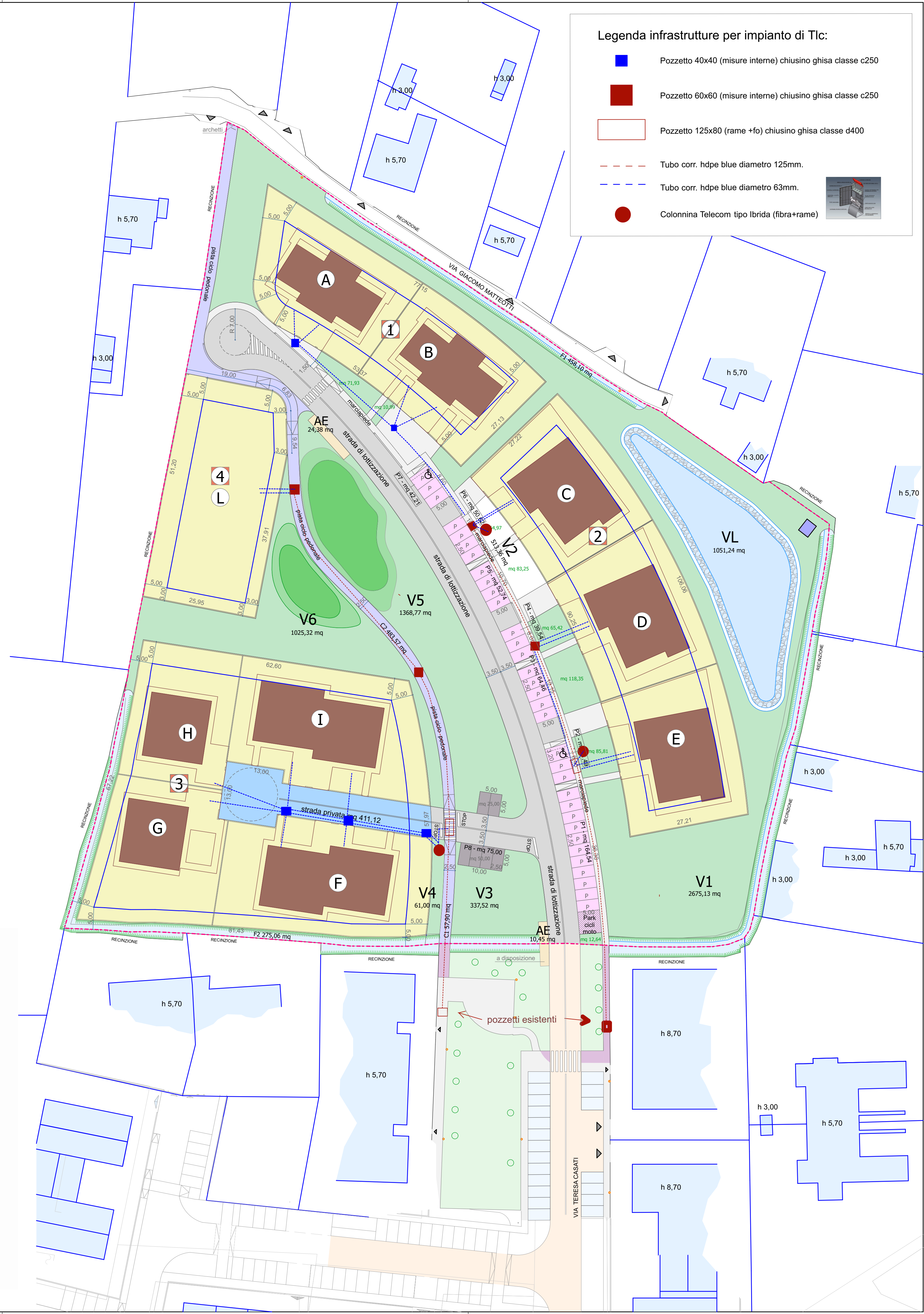
Figura A. 9 - Esempio di predisposizione per case a schiera con armadietto o colonnina
